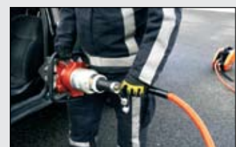
Met CORE™ Technologie kunt u gereedschappen aansluiten en ontkoppelen zonder dat de olietoevoer naar de slang onderbroken wordt
