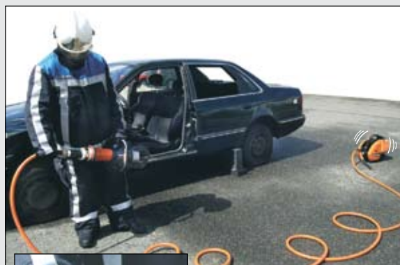
Sluit een gereedschap op ieder moment aan, zonder 'neutral' te selecteren op de pomp
