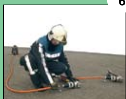
Sluit 2 andere gereedschappen aan, d.w.z. 2 koppelingen. N.B.: gereedschappen kunnen bij het voertuig worden aangesloten bij ononderbroken oliestroom
